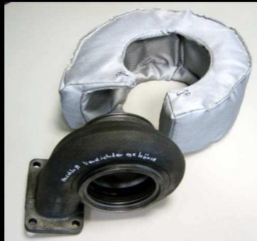
Turbolader sind in der Regel sehr heiß. Dies führt dazu, dass der Motorraum sich stark aufheizt. Elektrische Anschlüsse, die in der Nähe liegen, werden durch die Hitzestrahlung beschädigt. Sofern der Motor in einer Kapsel betrieben wird, heizt sich diese stark auf, was wiederum alle Bauteile vorzeitig altern lässt.
